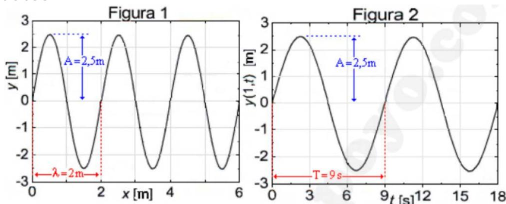
$$\text{Longitud de onda} = \lambda = 2 \text{ m.}$$
